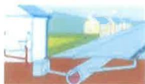
Il est constitué d'une seule canalisation qui collecte toutes les eaux usées et pluviales pour les acheminer vers la station d'épuration
