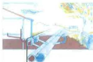
Il est constitué de deux canalisations : l'une collecte les eaux pluviales et les rejette au milieu naturel, l'autre collecte les eaux usées et les achemine vers la station d'épuration
