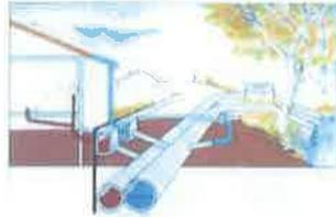
Il est constitué de deux canalisations : l'une collecte les eaux pluviales et les rejette au milieu naturel, l'autre collecte les eaux usées et les achemine vers la station d'épuration
