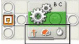
Le bloc de la zone de programmation donne une estimation de ce que le bloc exécutera. Dans le cas présent, le NXT va réagir aux sorties B et C (ce qui signifie qu'il ira tout droit) en avançant, et à niveau de puissance de 75% pendant une certaine durée. Le choix des blocs apparaît en bas de l'écran.
