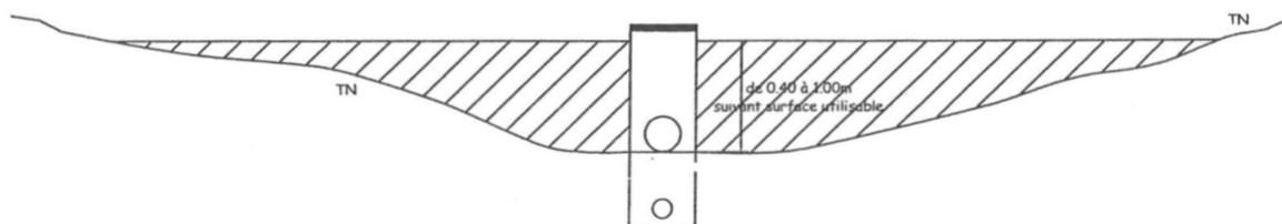
Ex: il faut environ  $10\text{m}^2$  de surface inondable à 0.4 -0.5m moyen de profondeur pour obtenir un volume de régulation d'environ  $4\text{m}^3$  nécessaire pour une surface étanche raccordée de  $120\text{m}^2$ ,
