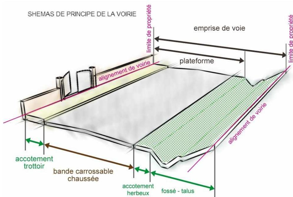
Les *voies* automobiles nouvelles doivent avoir une largeur de voie (*chaussée* et *accotement*) supérieure ou égale à 5 m. Une largeur supérieure peut être demandée pour les *voies* primaires des *opérations d'aménagement d'ensemble*.
